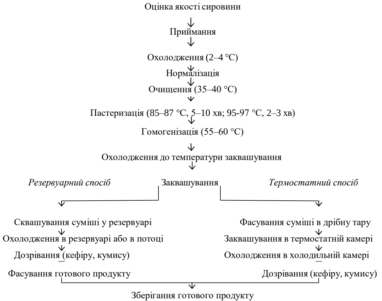
Рис. 25. Загальна технологічна схема виробництва кисломолочних продуктів
