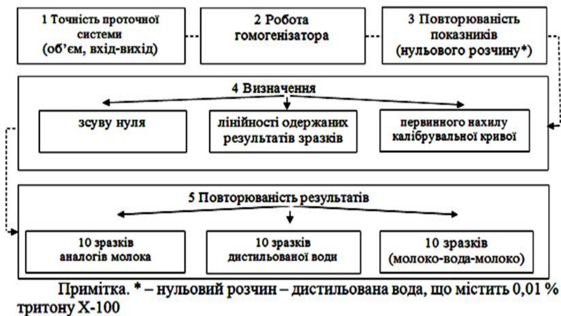
Рис.5.3. Схема технологічного процесу перевірки надійності вузлів і систем аналізатора за використання розчинів та зразків за температури 40 °С
