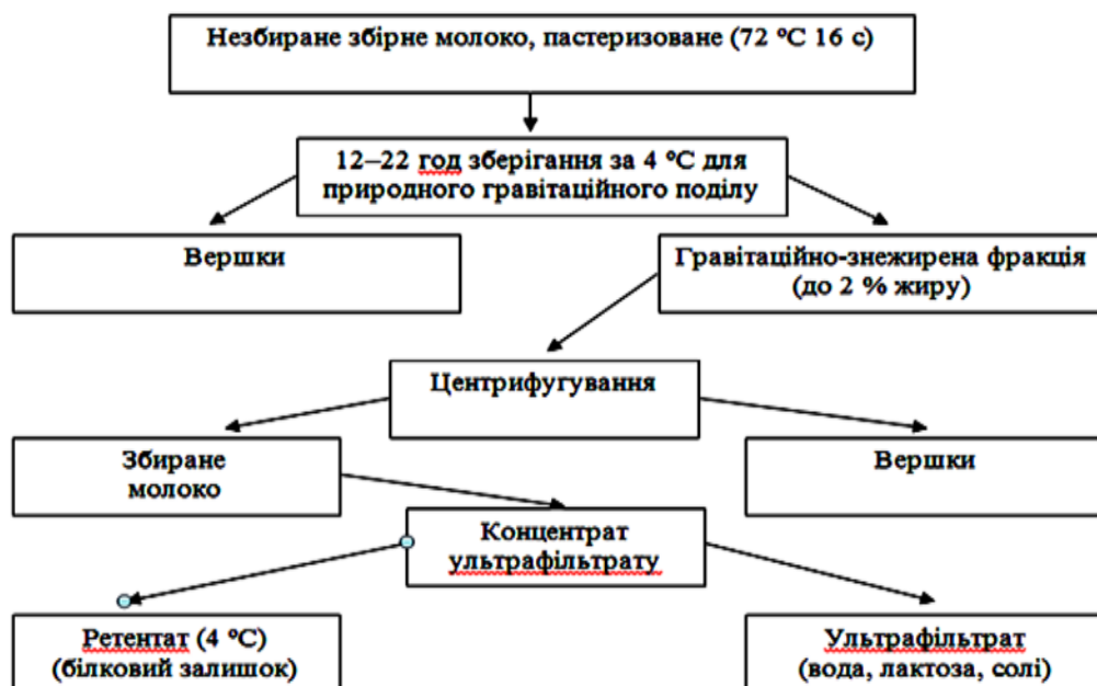
Рис. 5.4. Блок-схема процедури виготовлення стандартного зразка молока
