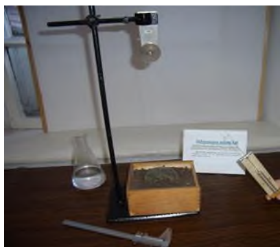
Рис. 8. Визначення коефіцієнта вязкості ґрунту
