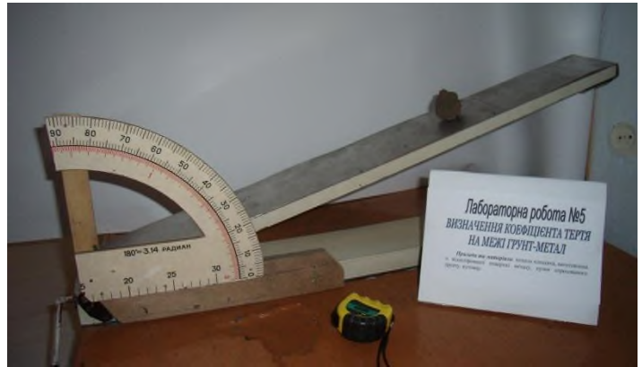
Рис. 6. Визначення коефіцієнта тертя на межі ґрунт-метал
