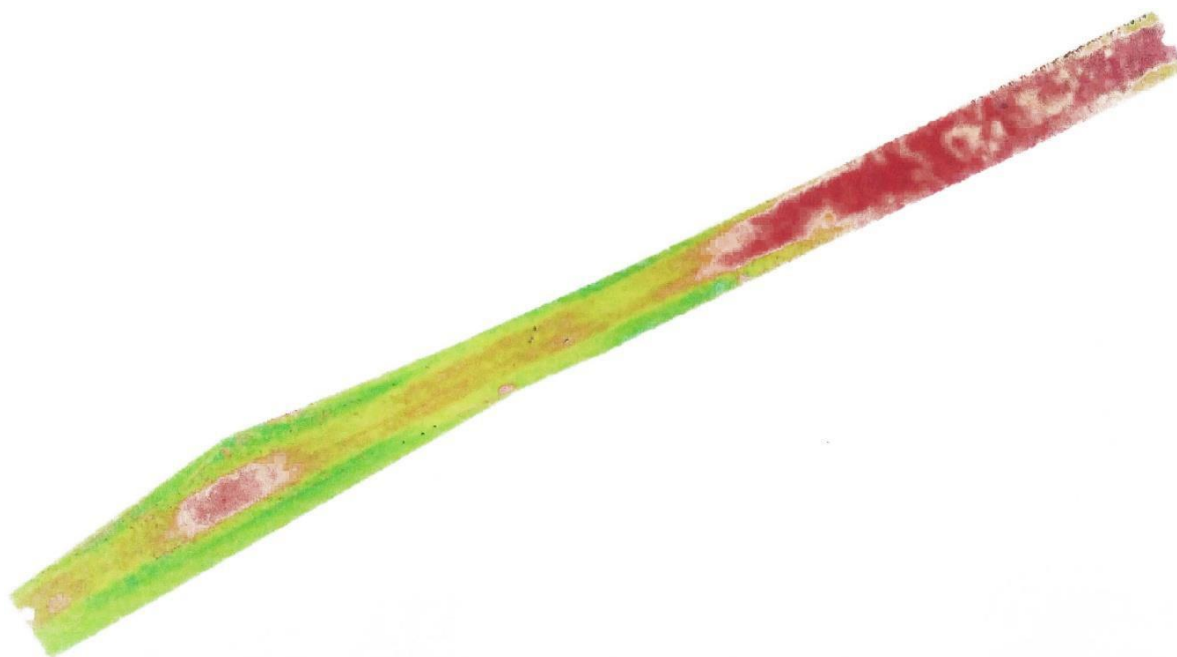
Рис. Б.11 Абрис накладених TIN-моделей нерегулярної поверхні проїжджої частини з двох останніх сканувань на шостому відрізку
