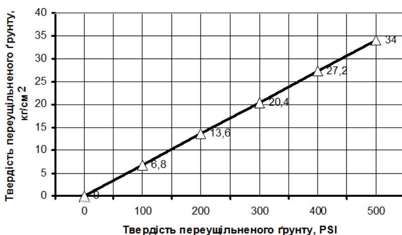
Рис. 7. Номограма переведення показів манометра пенетрометра з одиниць PSI (фунт на квадратний дюйм) в одиниці метричної міри
