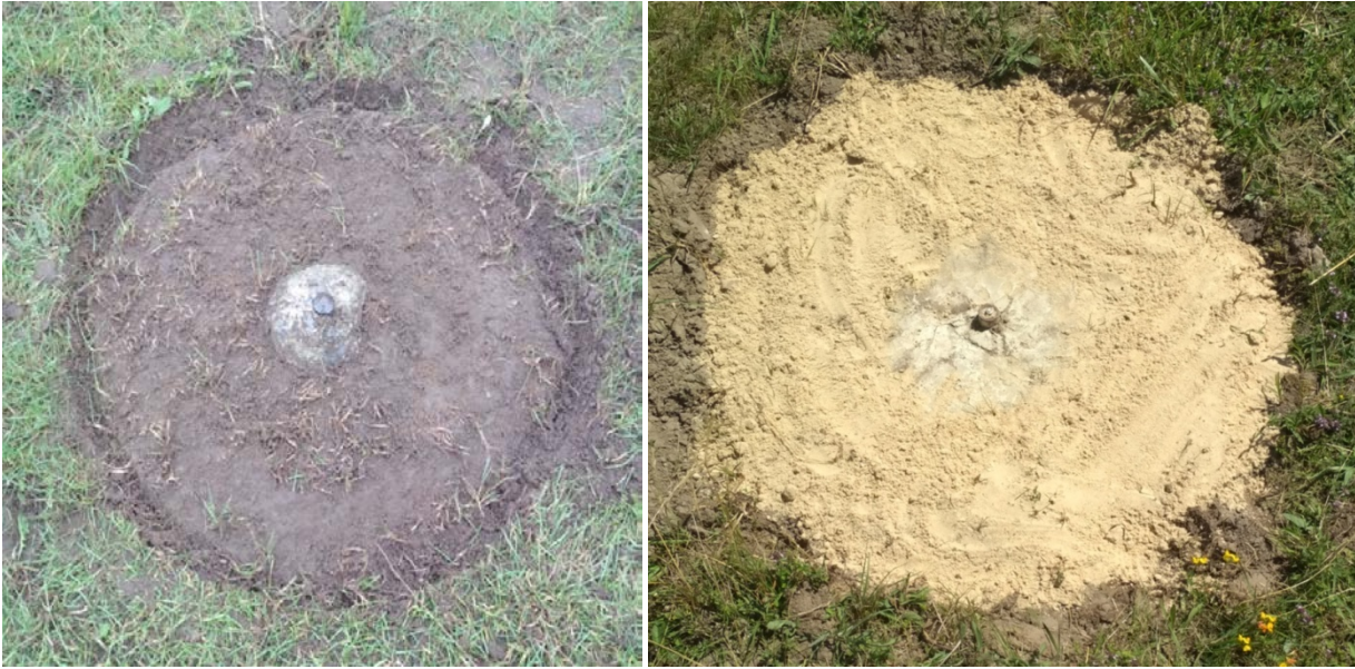
Рисунок 1.2 – Маркування опорних точок: а) окопка; б) обсипання піском
