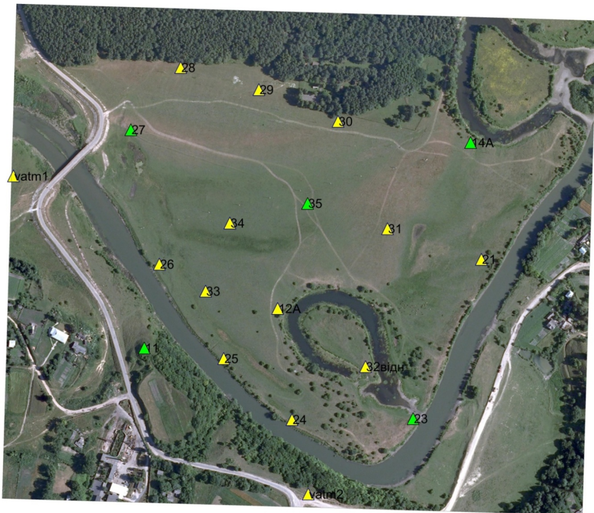
Рисунок 1.1 – Опорні пункти навчального геодезичного полігону використані для прив'язки знімків
