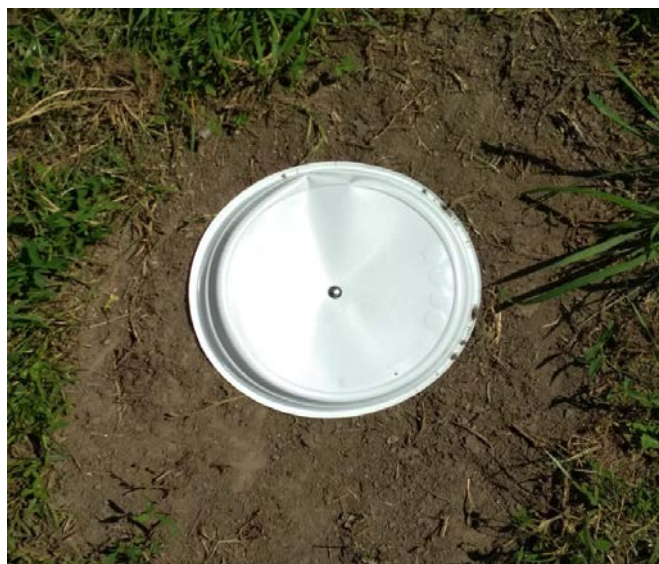
Рисунок 1.4 – Маркування контрольних точок регулярної і нерегулярної сітки
