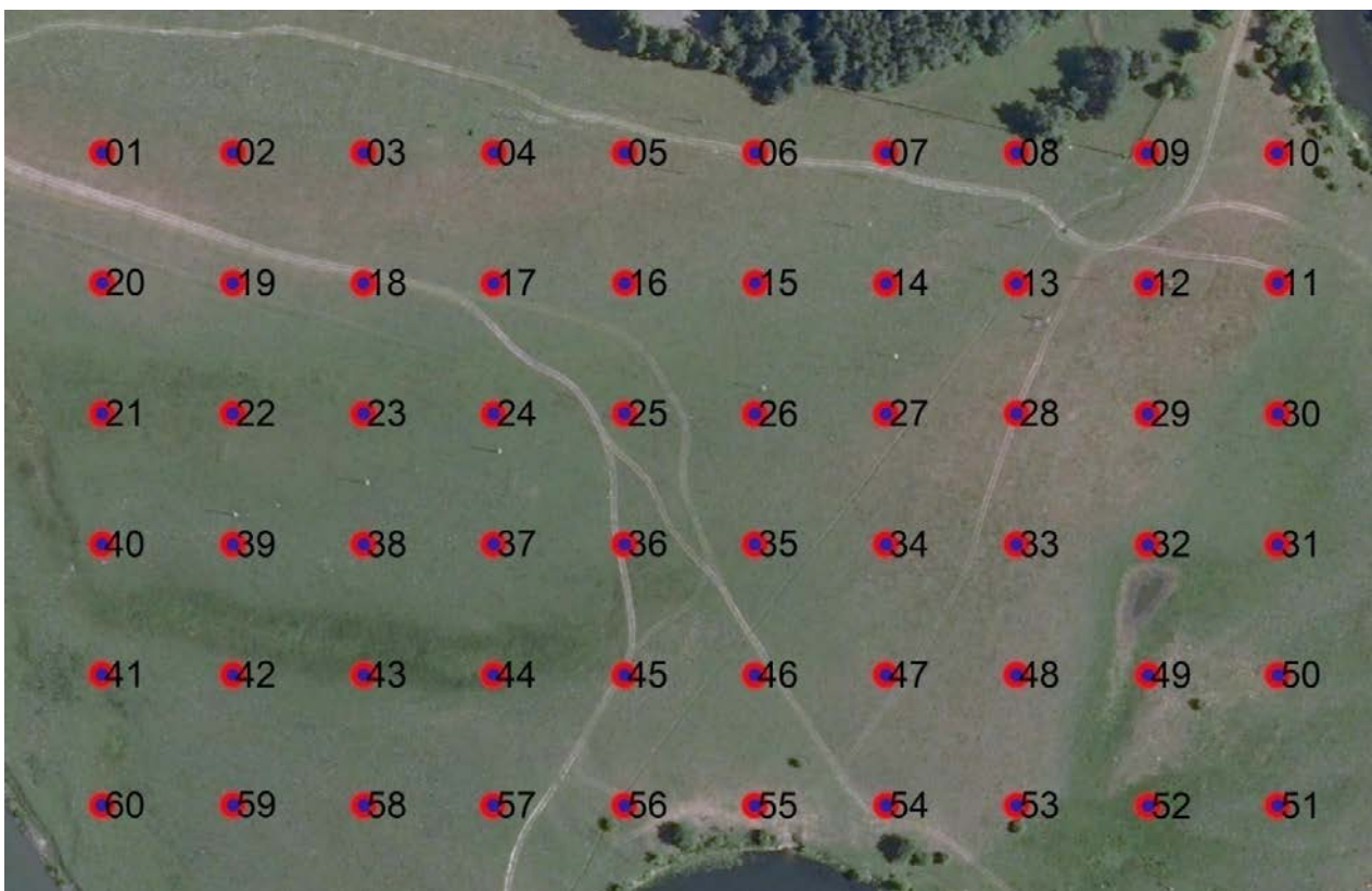
Рисунок 1.2 – Схема нумерації контрольних пунктів регулярної сітки
