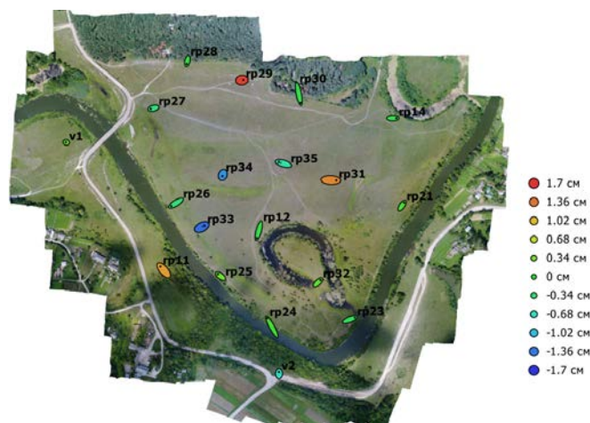
Рисунок 1. – Схема використаних 18 опорних точок та оцінка точності їх положення при прив'язці даних знімання з висоти 200 метрів
