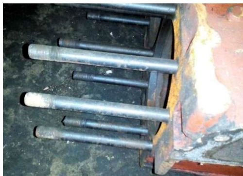
Рисунок 1 – Шпильки ГБЦ перед складанням двигуна А-41.
