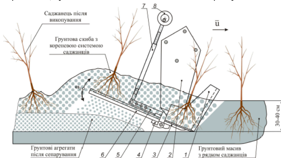
Рис. 1. Конструктивно-технологічна схема робочого органу плуга для викопування саджанців плодових дерев: 1 – викопувальна скоба; 2 – стійка; 3 – башмак; 4 – тра-верса; 5 – важіль; 6 – розпушувач; 7 – ексцентрикова тяга; 8 – ексцентриковий механізм
