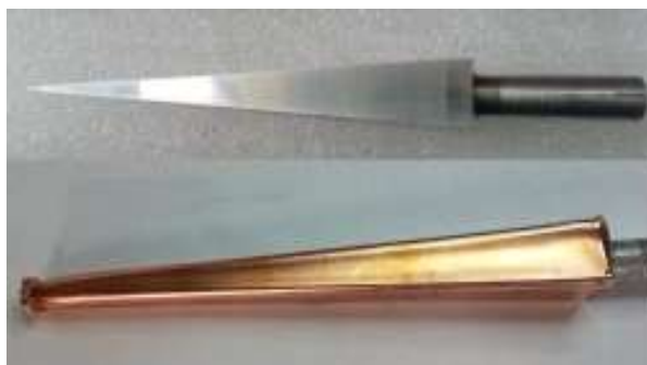
Рис 2. Форма для отримання хвилеводу та сформований на ній мідний хвилевод [1].
